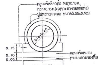
แบบระบระบายน้ำในผิวจราจร SCALE 1:25
